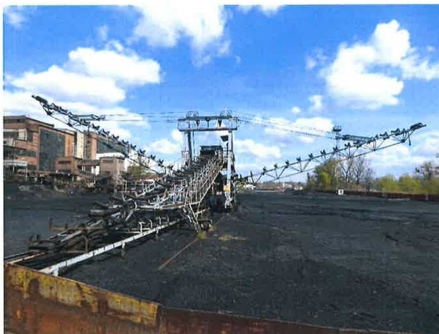
17. Pomost łączący stację przesypową nr V ze stacją przesypową nr VI 2b/3-13 (Zwałowarka dwuwysięgnikowa).
